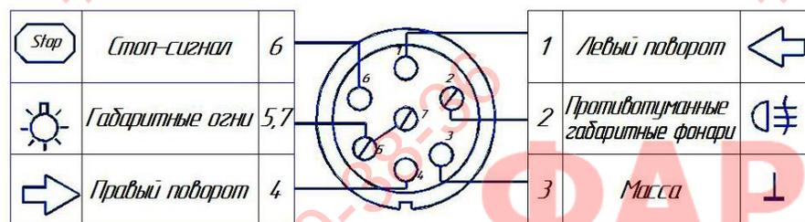
Схема подключения электрооборудования
